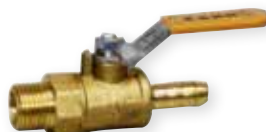
球阀 进气: 1/4" NPT 出气: 1/4" Hose Nipple
